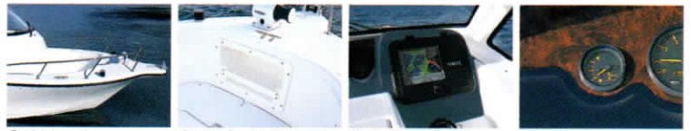
①パウレール ②パウロッカー ③ナビゲータBOX ④トリムメーター
