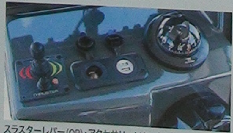
スラスタレバー(OP)・アクセサリソケット・コンパス(用品OP)
