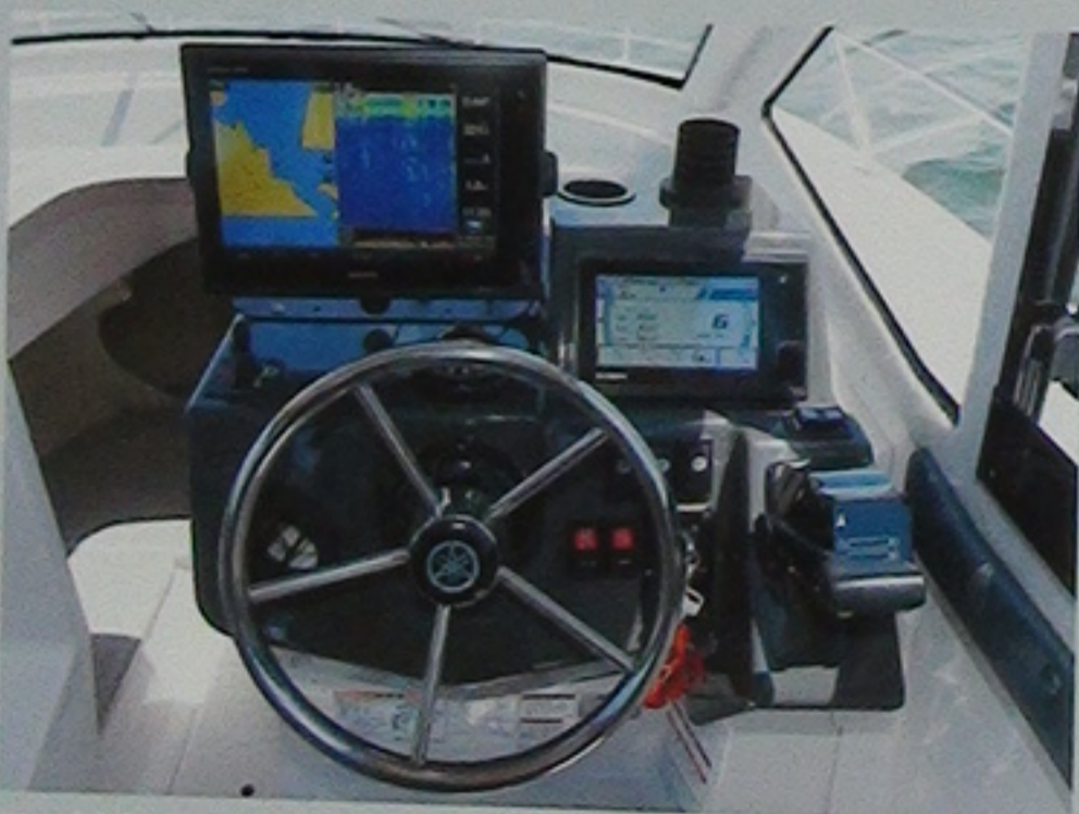
コックピット タッチスクリーンディスプレイ「CL7」を採用。フレッシュエアファン(OP)は外気を取り入れることができるため、空調効果が得られ、また、取り入れた外気をフロントウィンドウに当たった場合には、曇り止めの効果を発揮します※諸条件により、空調や曇り止めの効果は変化します。
