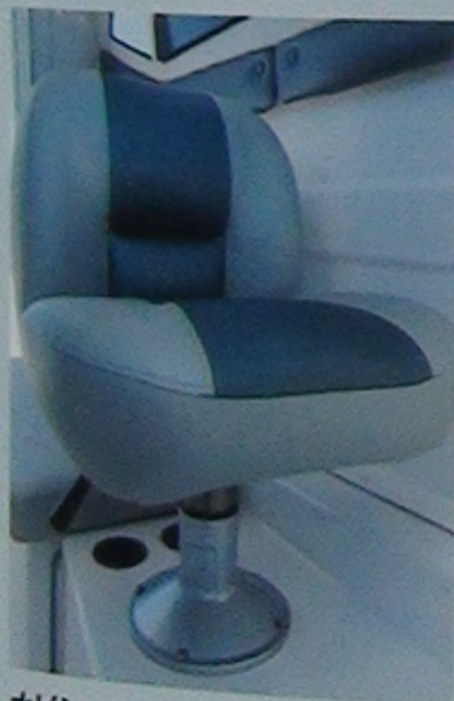
ナビシート ドライバーと同じ目線で、良好な前方の視界を確保するナビシート。EX仕様にはスライド&油圧ダンパー式を採用しています。
