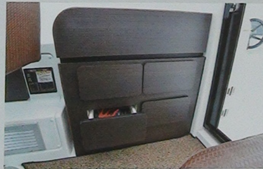
サイドロッカー キャビン入口の右舷側に小物などの収納に便利なサイドロッカーを配置。上部のボードを倒すとテーブルとしても使用できます。また、木目調の素材を使用し、質感を高めています。
