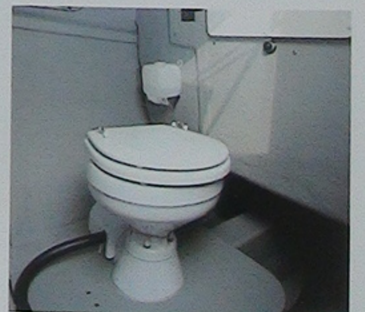
トイレルーム・電動マリントイレ(OP)
