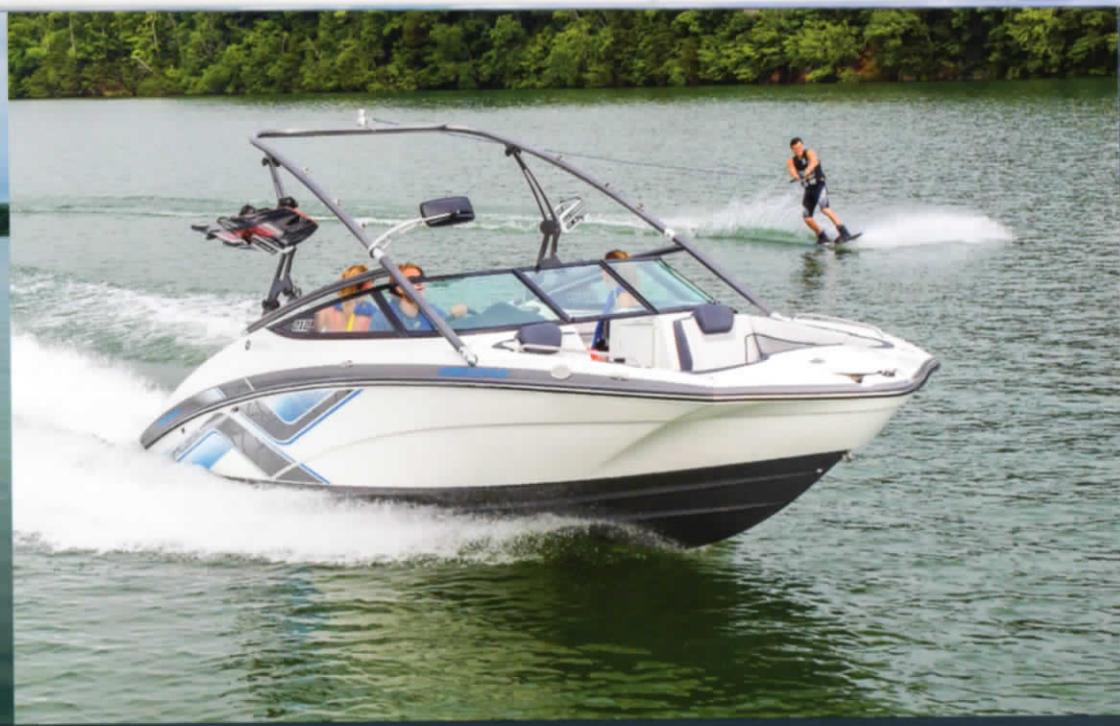
高性能1.8リットルNAエンジン2基掛けによる力強い走りと、約380リットルのウォーターバラストタンクによって作り出す大きな曳き波が、ウェイクトリックの可能性を広げます。簡単なボタン操作でウェイキバランスをコントロールできるほか、プレーヤーを視認しやすい大型ミラーやボードラック付き可倒式ウェイクゲート、マリンスポーツギアの大容量収納スペースなど、トーイングプレイを楽しむための装備が充実。新素材のSEAデッキマットを採用した大きなスイミングプラットフォームは、ウェイクボードの着脱に便利だけでなく、多彩なマリンプレイにも対応。212Xは、トーイングプレイのステージとして、プレーヤーの可能性を広げています。
