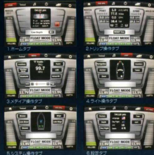
【主な機能】 燃費速力(平均)/タコメーター/オドメーター(走行計)/アフター/燃料計(残量表示)/エンジン温度計/バッテリー電圧表示/水深計(浅瀬アラーム)/水温計/警笛/航海灯操作/各ライト操作/オーディオ操作/ビルジ&ブLOWER操作/シャワー操作(242Limited S)/自船傾度/単位設定変更/時計
