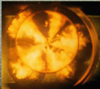
シリンダ内での燃焼状態
