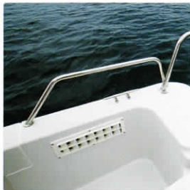
アフトデッキでのフィッシングや 移動時の安全性を高める [スタンレール]
