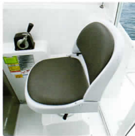
座り心地がよく快適な 運転姿勢がとれるダンパー付 スライド式の [ドライバーズシート]
