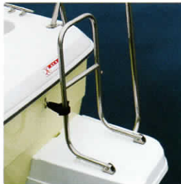
海へ簡単に昇り降りできる [ボーディングラダー] ※トランサムステップ選択時に設定可能
