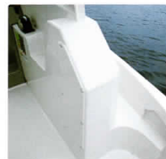
アフトステーションスペース ◎ハンドルとリモコンを別途現地艀装すれば、二箇所操船ができます。
