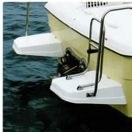
プロペラの点検などに便利な [トランサムステップ] & [トランサムレール]
