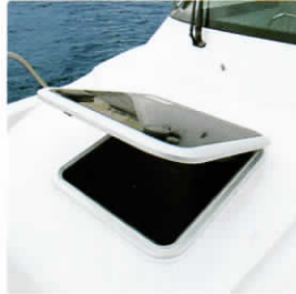
パウバース内に日光を 採り入れ換気も簡単にできる [スカイライトハッチ]
