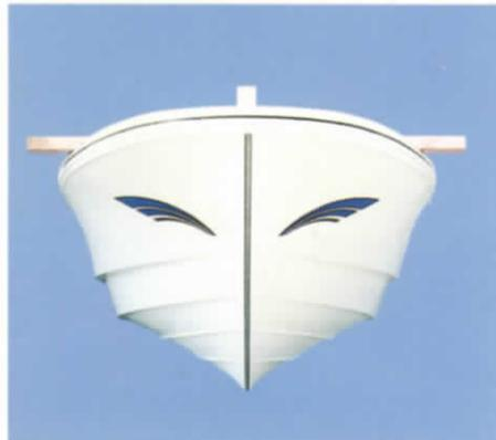
**①卓越したスピード性能** 凌波性・耐航性に優れたV型船型に、波切りの良いストライプを施し、卓越したスピード性能を実現しました。また、容量150ℓの燃料タンクを標準で装備し、長時間航行を可能にしています。
