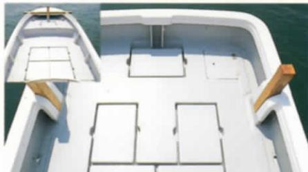
**③作業性を高めたデッキスペース** ワイドデッキに、ハッチはすべてフラッシュタイプを採用。また最適な高さに設定されたブルワークにより、作業性を一段と向上しています。
