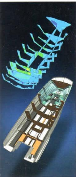
ヤマハの3D設計/型加工技術・構造解析技術を駆使し、船体強度を維持しながら軽量化を実現する「ストリンガー構造」を開発。横方向の骨を主体とするバルクヘッド構造と呼ばれる従来方式の構造に比べ、縦ロンジと呼ばれるストリンガーを主骨とし、FRP製とすることで、形状の自由度からの最適レイアウトにより船体の無駄な肉を排除。一方でストリンガーの一部に室内床機能を兼務させることで従来工法比約10~12%の軽量化を実現している。軽量化によるスピードへの貢献や、燃費の向上はもちろんのこと、部材の接着行程などを大幅に省略できることから環境有害物質(VOC)の発生を大幅に削減。さらに木材の使用も抑えることができるなど、環境への貢献にも効果を發揮する。
