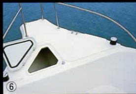
⑥ パウデッキ 一体成型パウスプリット/パウバルビット/アンカーストレージ
