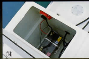
⑭ バッテリー&バッテリースイッチ 右舵側のスターンにバッテリーとバッテリースイッチを装備。
