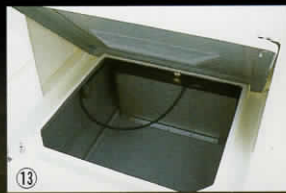
⑬ 燃料タンク 大容量123ℓステンレス製燃料タンク。予備タンク (オプション) スペース付です。
