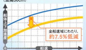
CKFP採用艇は着水時の衝撃が小さく、従来艇に対して、船体重心位置での上下加速度を全船速域で約7.5%低減しました。
