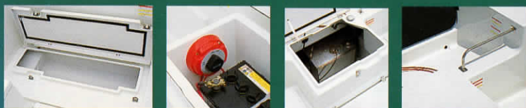
⑭竿入れ兼用スターンストレージ ⑮バッテリー & メインスイッチ ⑯燃料タンク (75ℓ) & ストレーナ ⑰スターンレール
